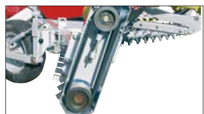
Stenräfsan drivs av en kraftig kilremstransmission.
