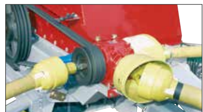
Kilremstransmission till inmatningsrotor.
