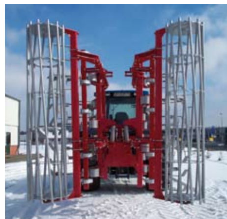
Vibro Flex 7400 ripiegato in posizione di trasporto.
