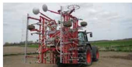
Con il telaio richiudibile in 2 sezioni si ottiene una larghezza di trasporto di 3,00 m.
