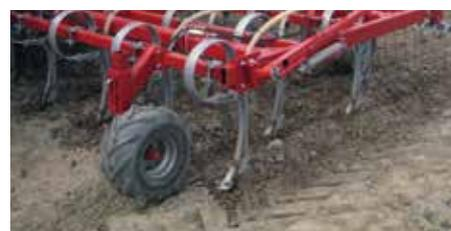
Il controllo della profondità è ottenuto in maniera ottimale da particolari pneumatici a sezione larga.
