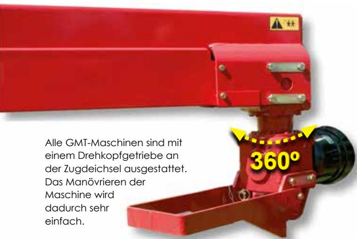
Alle GMT-Maschinen sind mit einem Drehkopfgetriebe an der Zugdeichsel ausgestattet. Das Manövrieren der Maschine wird dadurch sehr einfach.
