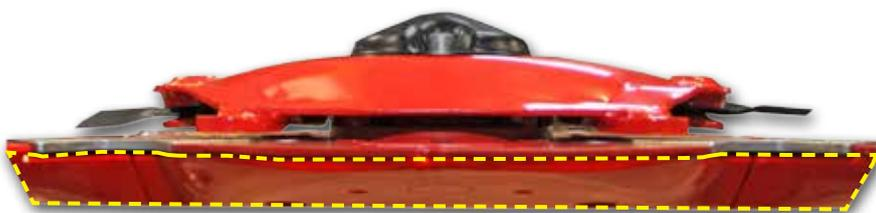
**Mähbalkenschutz.** Der Mähbalken ist effektiv gegen Steinschäden und Unebenheiten im Feld geschützt. Die Gleitkufen übernehmen die Funktion des integrierten Steinschutzes.
