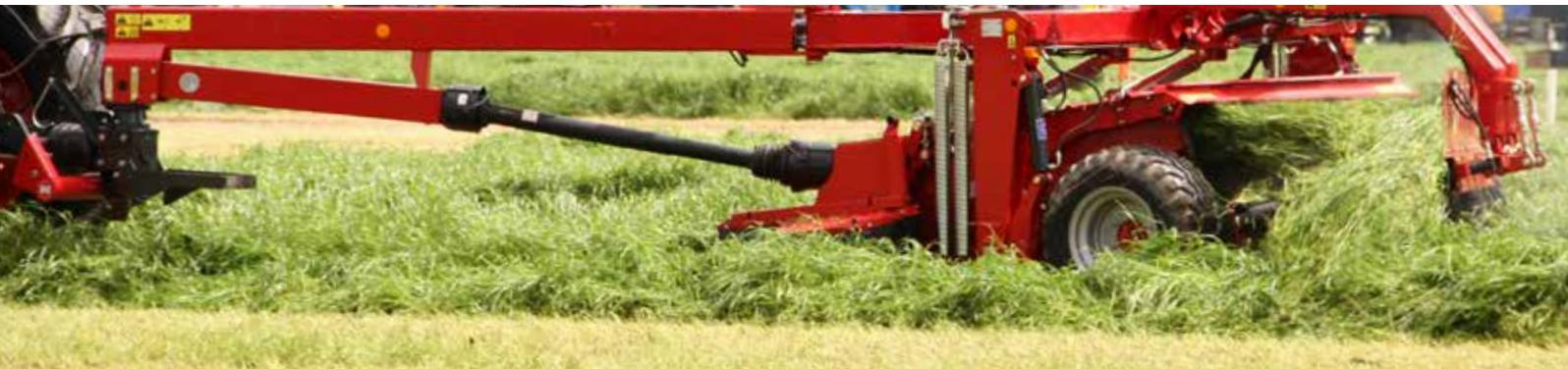
Mit dem Band für Schwadzusammenlegung, Collector, können Doppelschwaden für die nachfolgende Maschine abgelegt werden - zur Optimierung der Maschinenkette. Der Collector ist sehr effektiv, ungeachtet ob man mit GMT alleine oder in Kombination mit einem Frontmäherwerk arbeitet.
