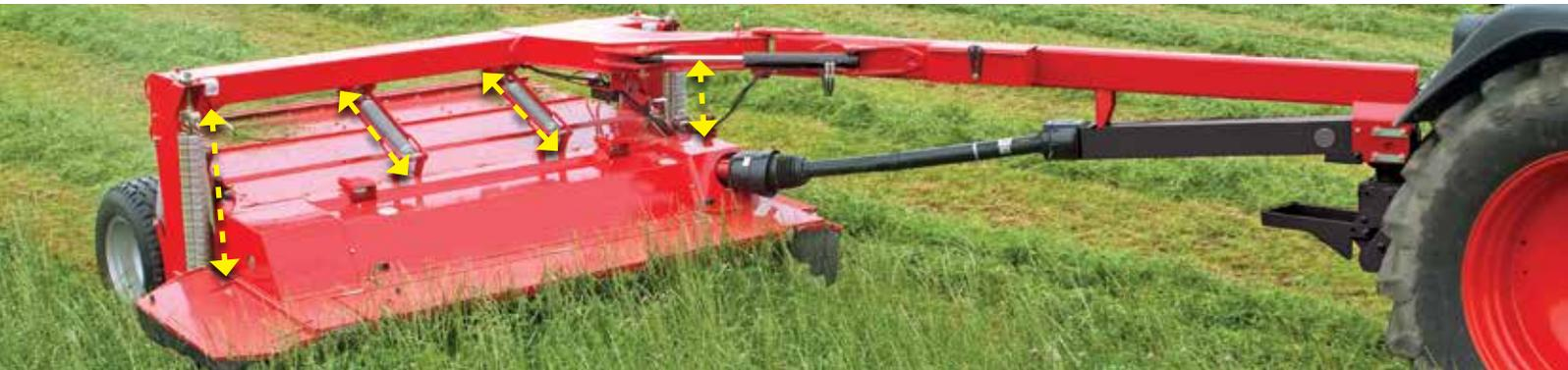
Top Safe besteht aus 4 seitlichen Federn, 2 Top-Federn und einer verstellbaren Zugbalkenverlängerung.
