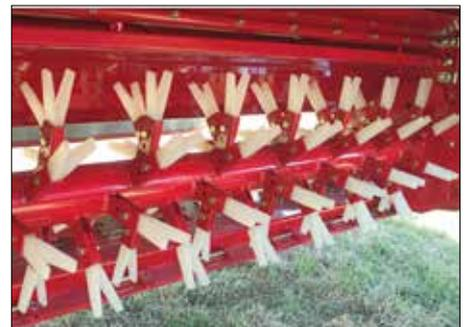
**PE-Aufbereiter:** Die PE-Finger leisten eine flexible und effektive Aufbereitung. Der Aufbereiter hat ein kleines Eigengewicht und der Wartungsaufwand ist minimal.
