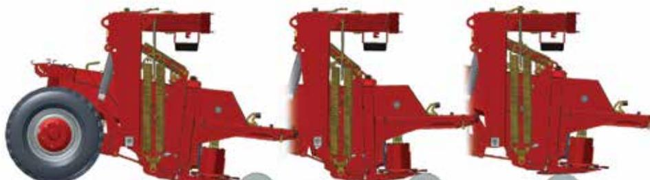
Wenn der Mähbalken auf einen Stein trifft wird die Topfeder automatisch zusammengedrückt, die Maschine wird angehoben und gleitet unbeschädigt über das Hindernis hinweg.
