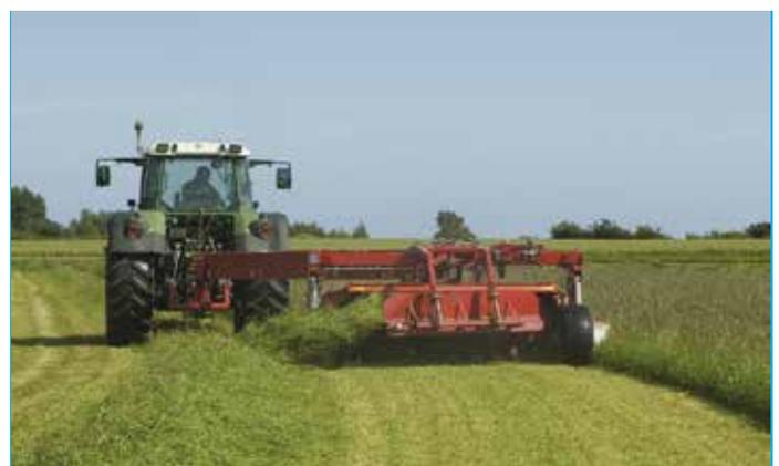
Wenn das Band für Schwadzusammenlegung, Collector, ein Doppelschwad ablegt, ist es nicht nötig, das Mähgut zusammenzurechen. Der Häcksler, Ladewagen oder Ballenpresse kann das Doppelschwad direkt auf sammeln. Damit wird die Grasernte effektiver.
