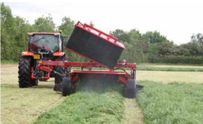
Beim Mähen des 1. Schwades wird die Bändeinheit angehoben und die Maschine legt ein normales Schwad ab. Beim Mähen des 2. Schwades wird der Collector für Schwadzusammenlegung aktiviert.
