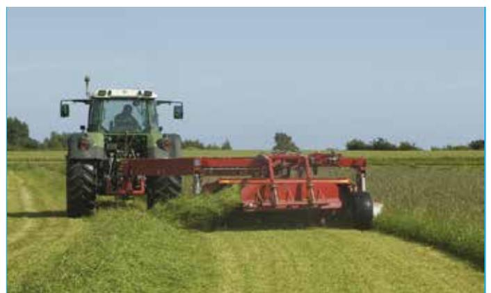
Lors du deuxième passage, le tapis récupère le flux de fourrage et le dépose sur le premier andain. Il n'y a donc plus besoin d'andainier, ensileuse, remorque autochargeuse ou presse peuvent le récolter, réduisant ainsi le nombre de passage.
