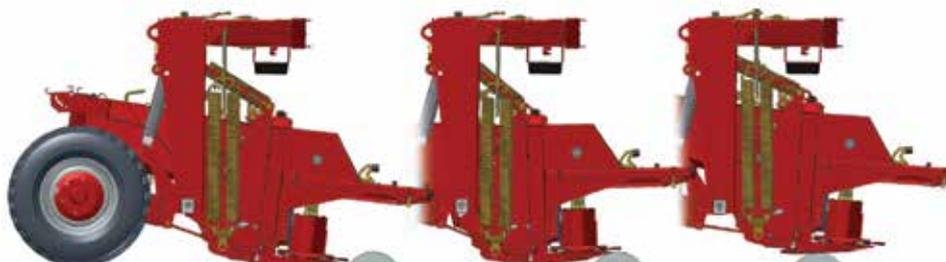
Si la faucheuse rencontre un obstacle, les ressorts horizontaux se compriment automatiquement et la machine se soulève de façon à passer au-dessus de l'obstacle sans dommage.
