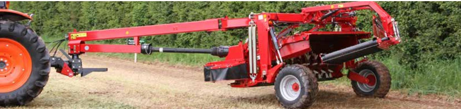
Toutes les faucheuses trainées Kongskilde sont équipées de tête pivotante grâce aux boîtiers girondines, elles sont ainsi très maniables. Il est donc possible de manœuvrer dans les endroits exigus aussi bien avec un timon central type Flex ou latéral. La rotation est possible jusqu'à 90° sans vibration ou effort pouvant créer des dommages.
