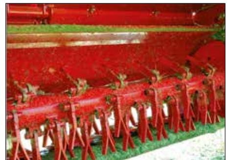
Conditionnement à doigts métalliques : ce conditionneur est particulièrement efficace dans les zones caillouteuses, évitant une usure prématurée.
