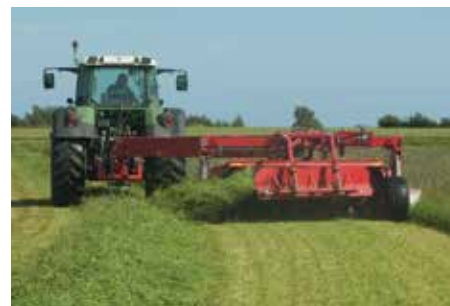
Stroje GMT L / Flex mohou být vybavené systémem Collector pro slučování řádků. Tak je možné ukládat sečenou hmotu na dvouřádky – to umožňuje optimalizovat řetězec strojů.
