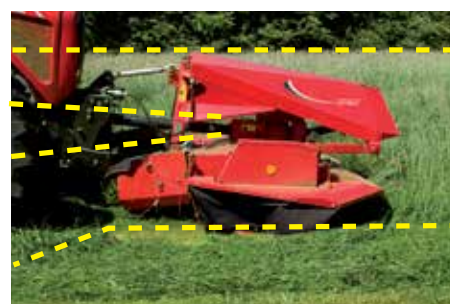
Contour Float – trvale rovnoběžně s terénem.
