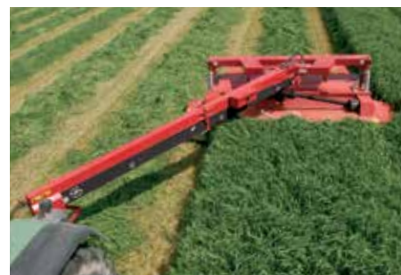
Stroje Flex mají dlouhou, robustní tažnou tyč uchycenou uprostřed stroje.
