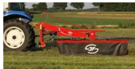
Shrnovač R+ 460 s nastavitelnou řádkovací plachtou
