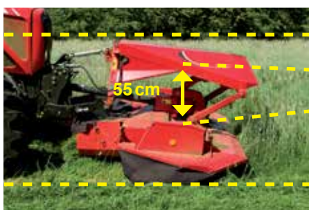
Contour Float – svislý pohyb až 55 cm.
