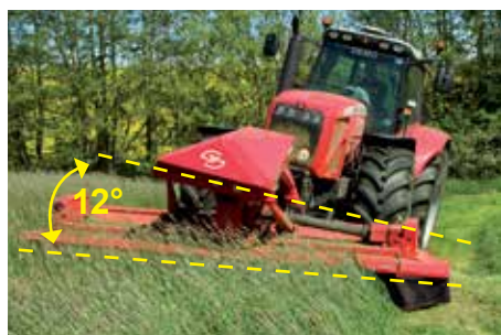
Contour Float – boční náklon až 12^\circ :
