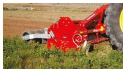
Avant du châssis caoutchouc oscillant.
