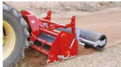
Le dessus du châssis en caoutchouc absorbe les impacts et permet de travailler en condition humide.
