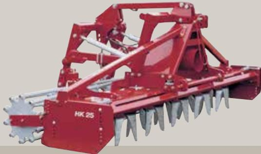
HK 25 avec rouleau cage et relevage arrière hydraulique (option)
