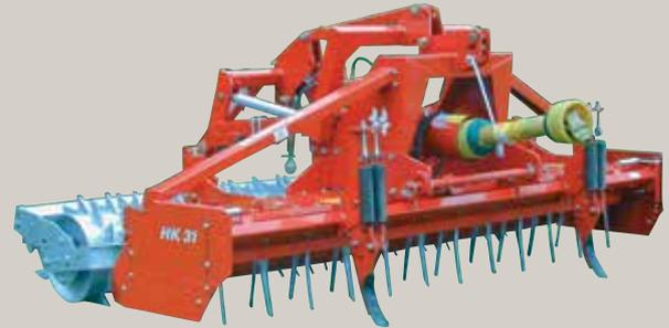
La herse rotative HK 31 est conçue pour les moyennes et grandes exploitations avec des tracteurs jusqu'à 170 ch afin de répondre aux exigences des agriculteurs et entrepreneurs
