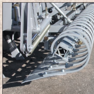
Sulyginimo lenta paruošia galutinį sėjimo pagrindą (šiltysvę, daigyną).
