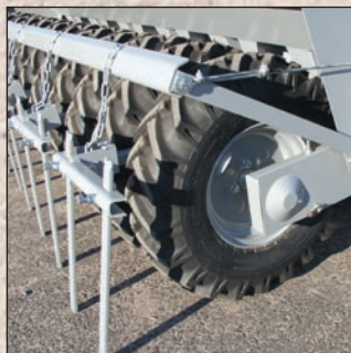
Patentuoti galiniai ratai yra padalinti į 0,5 metro sekcijas HT modeliuose.
