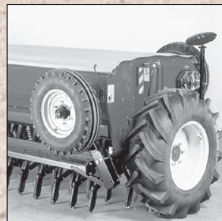
H modeliai turi šonuose išdėstytus ratus. Yra galimi atskiri transportavimo ratai.
