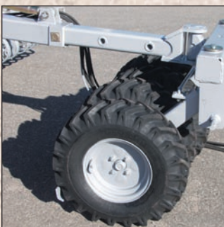
HT-S modeliai gali būti montuojami su priekiniais tankinimo ratais, norint sutankinti dirvožemį traktoriaus ratų plote.
