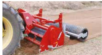
Die Gummimatte absorbiert Steinschläge und ermöglicht ein Arbeiten unter feuchten Bedingungen.
