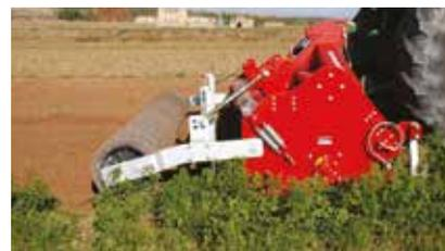
Der Siebkamm ist gefedert aufgehängt.
