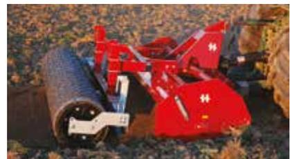
Die Planierschiene hinterlässt eine ebene Oberfläche.
