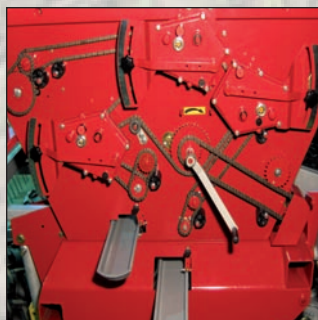
Alla inställningar sker vid samma sida. Enkelt att göra utmatningsprov..
