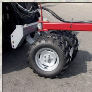
Kraftig mellanpackare med 7.50 x 16 hjul (alternativ utr.)
