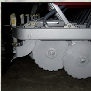
Gödselbillarna kan lyftas upp när de inte används (combi).
