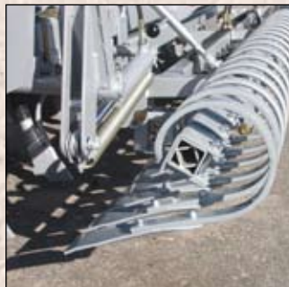
Flexplankan för alla bogserade modeller bearbetar såbädden i samma körning.
