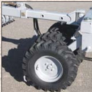
HT-modellerna kan utrustas med mellanpackare som trycker till jorden mellan traktorhjulen.
