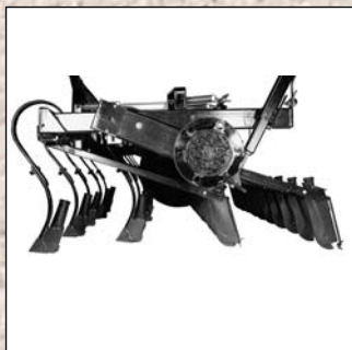
Gödselbillar och såbillar är monterade på fyra axlar i huvudramen.
