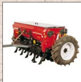
Combiseed H250 är en lättare version av bogserad 2,5 m kombisåmaskin.
