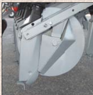
Släpbillen kan utrustas med en speciell skiva som håller den ren i förhållanden med växtrester.
