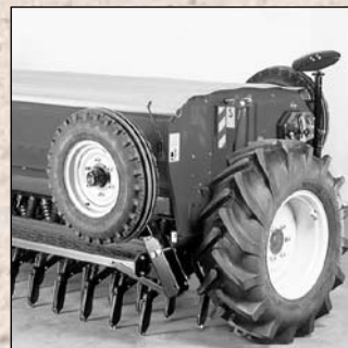
H-modellerna har hjulen placerade på sidorna. Separata hjul för långtransport finns som tillbehör.
