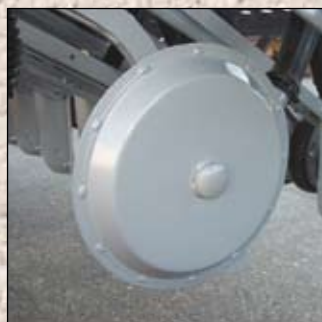
Skivbillen med djupbegränsare passar i lättare jordtyper.
