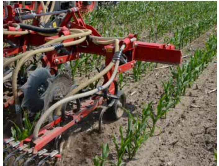
Herse peigne arrière simple intégrant et protégeant le diffuseur entre les rangs (avec option FS Seeder)
