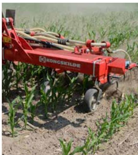
L'autoguidage par caméra permet d'augmenter la vitesse de travail, et donc, le débit de chantier.
