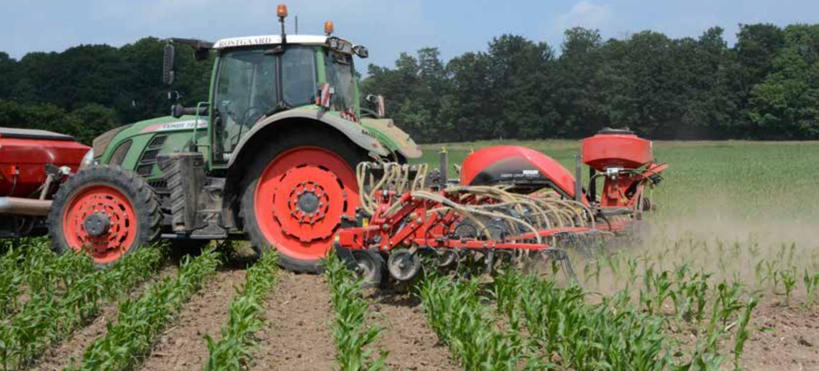
VCO-I disposant du contrôle des éléments. Le rang de gauche est en position relevée.
