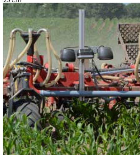
La hauteur et l'angle de prise de vue de la caméra s'adaptent en fonction de la culture et du stade de développement pour une grande précision.
