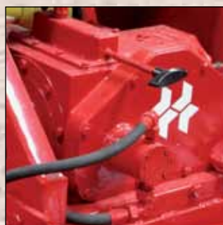
Scatola cambio della 700S-D con sistema di raffreddamento.
