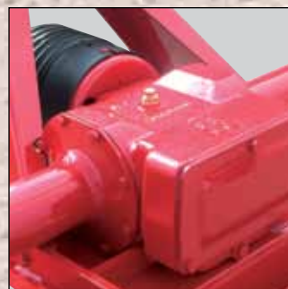
Scatola cambio standard a 4 velocità per le scelta accurata della velocità del rotore.
