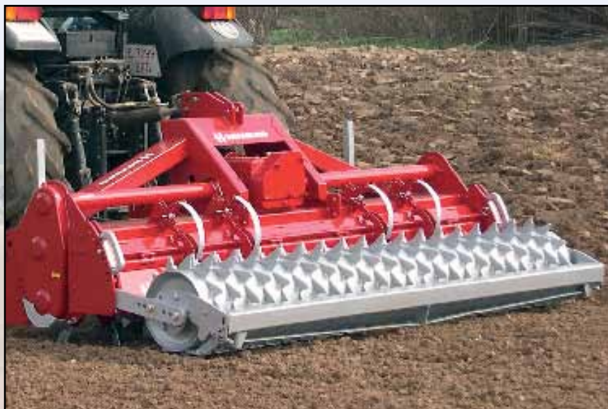
R600S-305S con rullo packer. I nuovi attacchi rullo hanno disegno molto compatto per limitare l'ingombro.
