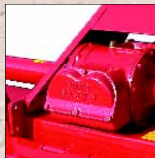
Scatola cambio rinforzata su misure 280 e 305 per trattori fino a 125 HP.
