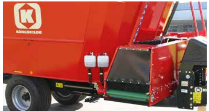
Seria B do profesjonalnego wysypu z przednim przenośnikiem transportowym VM-SB i VM-B, i opcjonalnie elewateorem bocznym.
