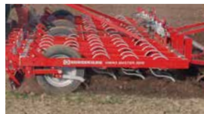
5 рядов зубьев обеспечивают свободное прохождение почвы и органических остатков.
