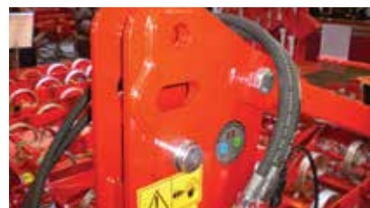
Пазы в сцепке позволяют культиватору следовать рельефу поля даже на холмистой местности что предотвращает перегрузку рамы.
