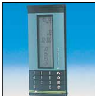
Komputer LH 5000 stosowany w siewnikach NCS 5100 z elektroniczną regulacją dawki wysiewu.
