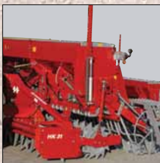
Masa siewnika jest przenoszona na wał zagęszczający narzędzia uprawowego. Głębokość siewu jest regulowana w stosunku do położenia wału.
