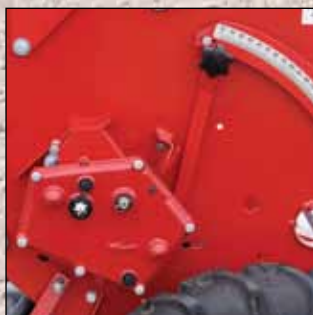
Bezstopniowa skrzynia przekładniowa do regulacji dawki wysiewu Vario-K
