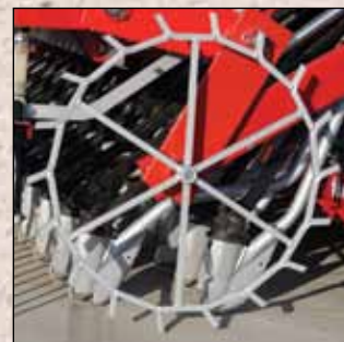
Duża średnica koła polowego zapewnia przekazywanie napędu ze stałą prędkością we wszystkich warunkach polowych.
