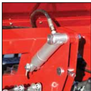
Hydrauliczna regulacja siły nacisku redlic dla siewnika NCS 3100 (wypożyczenie dodatkowe).
