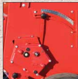
Bezstopniowa regulacja dawki wysiewu skrzynią przekładniową Vario-K.
