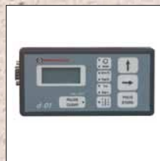
d-01 stosowany do sterowania zakładaniem ścieżek przejazdowych.
