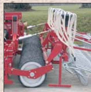
Zamontowanie sekcji redlic na wale zagęszczającym zapewnia uzyskiwanie dokładnej głębokości siewu.
