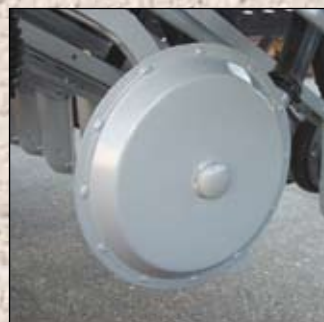
På slepelabben kan det monteres en spesialskive, som kan holde slepelabben ren under forhold med mindre planterester.
