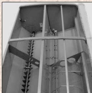
Fødemekanisme og alle deler forbundet hermed er fremstillet av rustfritt stål.
