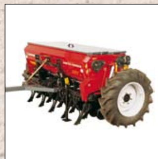
Combiseed H250 er en lettere versjon av en 2,5 M slept kombisåmaskin.
