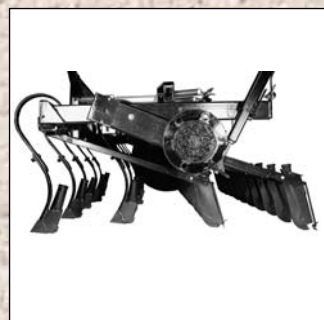
De patenterte pakkerhjul er montert i 0,5 m. seksjoner på HT-modellene.
