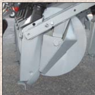
Skållabb med dybdebegrenser anbefales til lettere jordtyper.
