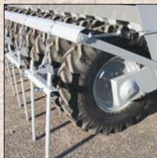
Gjødsellabben og sålabben er montert uavhengig på fire rekker i hoveddrammen.
