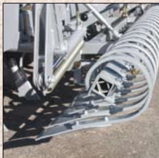
Flexiplanken lager det endelige såbed for såing.
