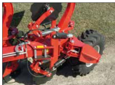
Hydraulische Tiefenkontrolle und Stollenprofil für obiges Kombirad.
