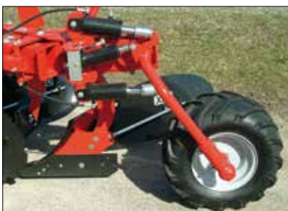
Hydraulische Tiefenkontrolle für Stützrad mit Stollenprofil.
