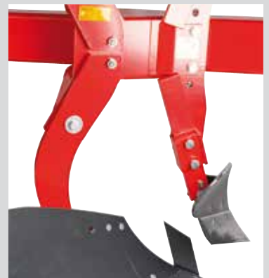
Scherbolzen: 16 mm Schraube in der Qualität 10.9, mit einer Bruchkraft von 4000 kg.
