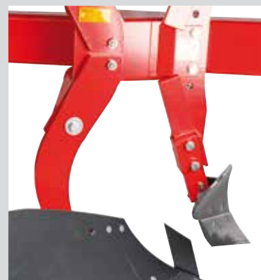
Surub de forfecare: calitate 16 mm x 10.9 cedeaza la peste 4.000 kgF
