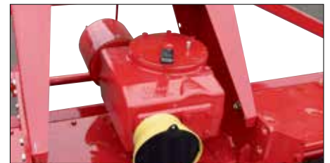
Drie snelheden schakelkast met doorgaande aftakas.
