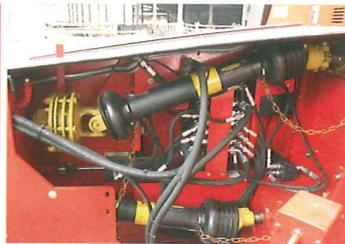
Das Gewicht ermittelt der Computer mit vier Wiegezellen unter dem Behälter. Die Daten werden drahtlos an die Haupt- und Handterminals weitergeleitet (li). Das Getriebe ist für Servicearbeiten schnell zugänglich und ist für den Betrieb mit kleineren Schleppern einmal schaltbar (re).
