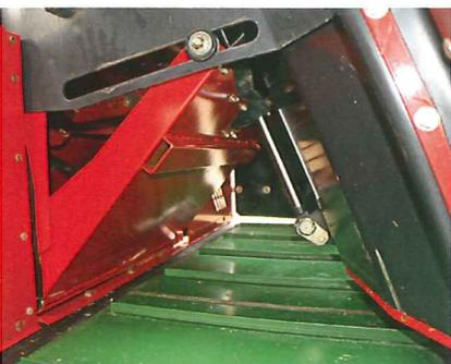
Hydraulisch wird der Strohhotor über das Austragband geklappt und der Weg zur Turbine ist frei.
