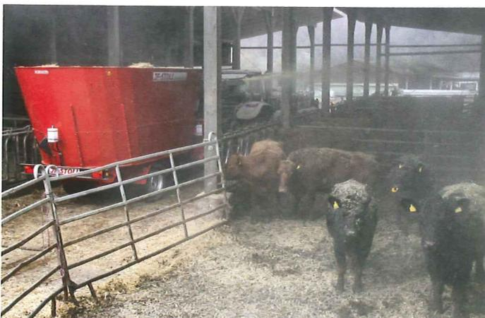
Die Einstreufunktion ist ein schönes Extra für den Futtermischwagen. Die Strohballen werden von den Schnecken zuverlässig aufgelöst und geschnitten. Das Auswurfgebläse lässt sich in alle Richtungen steuern.
