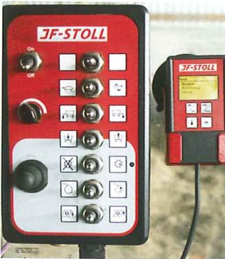
Das Bedienterminal im Futterwagenschlepper zusammen mit dem Handterminal, welches im Batteriebetrieb portabel ist.
