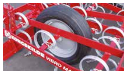
Koło ogumione 165 x 15" seryjnie dla SQ. Koło ogumione 6.00 x 12" seryjnie dla SGC.
