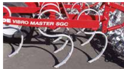
Zęby typu S z odwracalną ultra redliczką.
