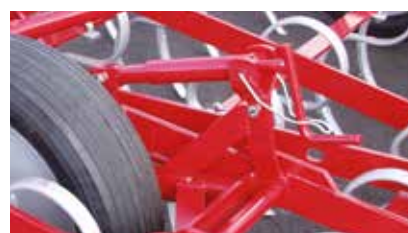
Skala regulacji głębokości.
