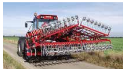
Segmenty boczne są składane nad ramę podstawową w położeniu transportowym.
