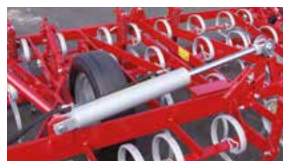
Siłownik hydrauliczny dwustronnego działania.
