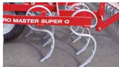
Zęby typu SQ z odwracalną ultra redliczką.
