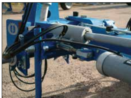
Śruba dwustronna równoważy wszystkie siły boczne w celu ograniczenia do minimum potrzebnej siły uciągu.
