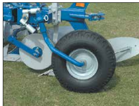
Koło wielofunkcyjne: regulacja głębokości/transportowe. Średnica 710 mm, szerokość 264 mm.
