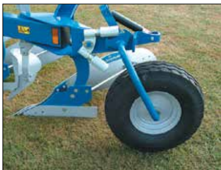
Koło ogumione regulacji głębokości orki 7,00x12. Średnica 645 mm, szerokość 182 mm.
