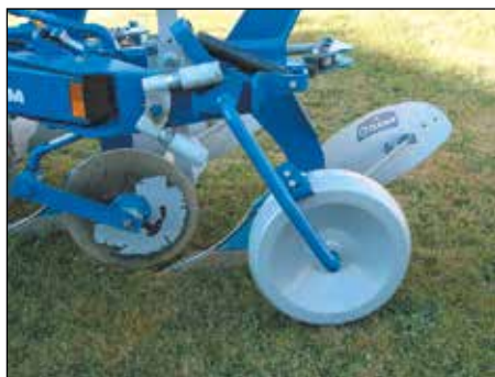
Koło stalowe regulacji głębokości orki. Średnica 500 mm, szerokość 160 mm.
