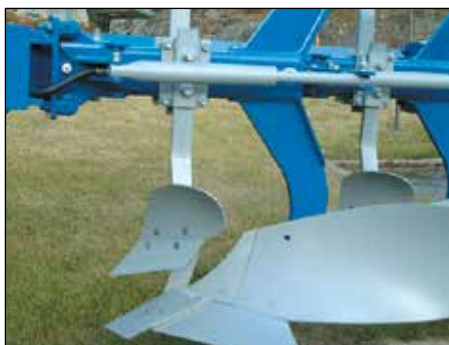
Przedpług EG. Orka płytką o szerokiej skibie. Dobrze współpracuje zarówno z krojem tarczowym jak i krojem płetwowym.
