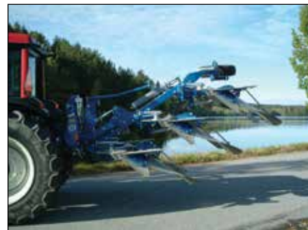
Ze względu na fakt, że korpusy są obracane pod ramą, środek masy narzędzia zbliża się do ciągnika i pług jest łatwiejszy do podniesienia.
