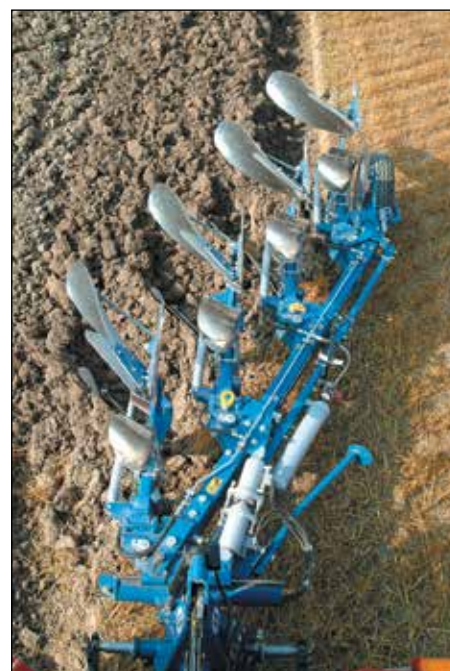
Dokładne pasowanie połączeń śrubowych dało możliwość zastosowania stalowej, hartowanej ramy głównej o wytrzymałości o 40% większej w porównaniu do standardowych ram rurowych.
