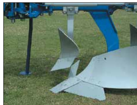
Przedpług EM. Daje sobie radę z dużą ilością resztek poźniwnych. Najlepiej współpracuje z krojami płetwowymi.
