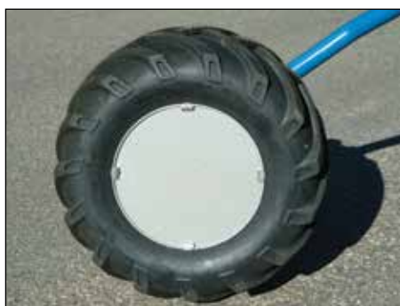
Koło zewnętrzne w pługach serii CX Plus. Przeciwdziała przykrywaniu gleby
