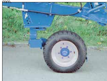
Koło wielofunkcyjne w przednim położeniu dla modeli Xcelsior DX. Średnica 755, szerokość 275.
