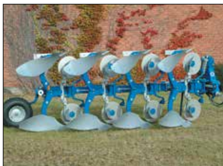
Pług Vari Flex CX 4975 F z krojami tarczowymi i przedpłużkami typu EG. Zarówno korpusy płużne jak i przedpłużki są wyposażone w niezależne ścinane sworznie.
