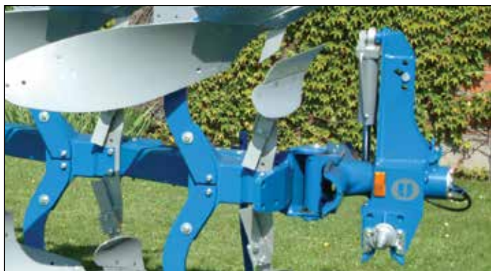
Model Xcelsior CX jest wyposażony w nowo zaprojektowany wspornik układu zawieszenia z tatką w użyciu szybkozłączną poprzeczną belką.
