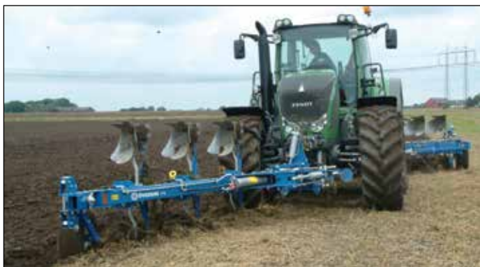
Połączenie pługa Vari Flex EX 6975 H z pługiem FX 31075 H montowanym z przodu ciągnika zwiększa wydajność orki, ponieważ robocza szerokość połączonych w ten sposób pługów wynosi aż 4,5 metra. Efektywna obróbka gleby przy obniżonych kosztach!
