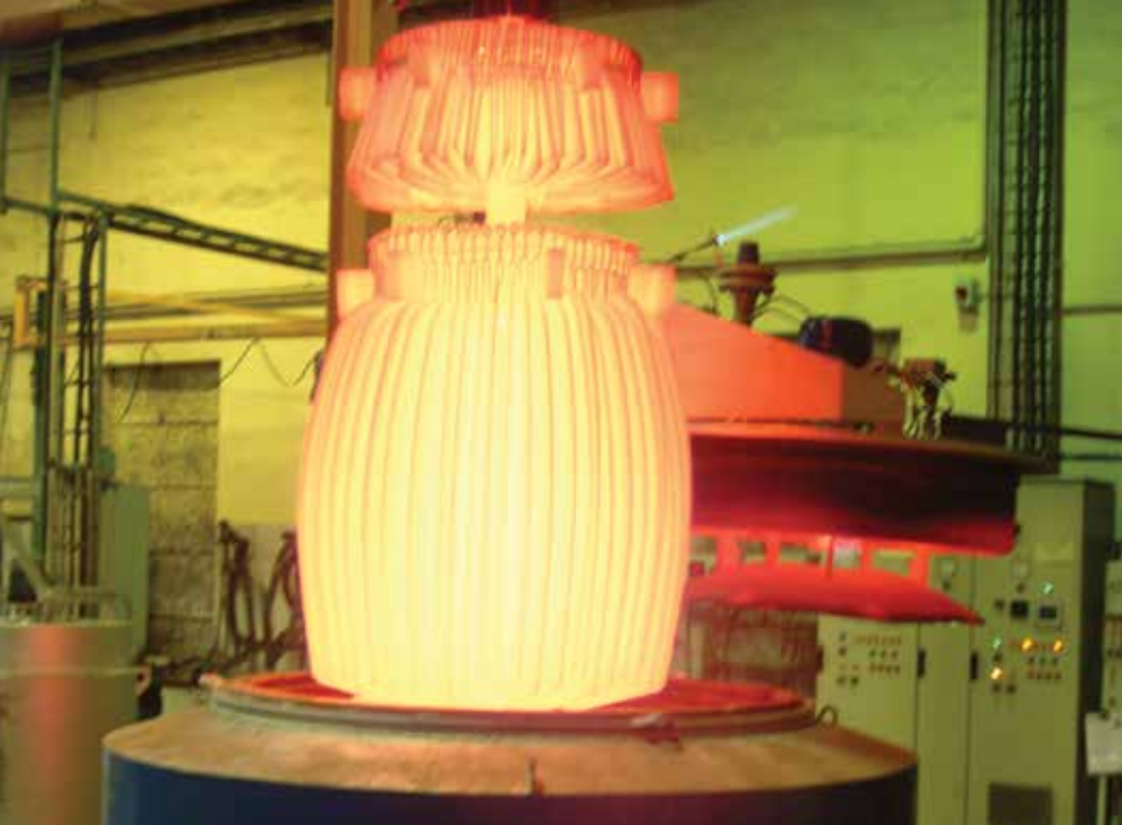
Nawęglanie wstępnych odkuwek odkładnic pługów.
