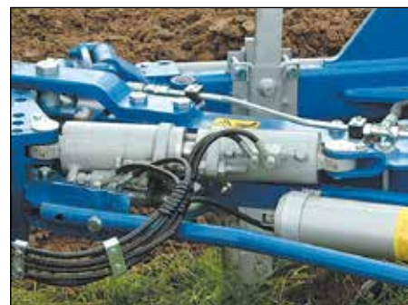
Podwójny siłownik zapamiętuje ustawienie szerokości orki podczas ustawiania narzędzia w osi ciągnika i obracania korpusów płużnych.
