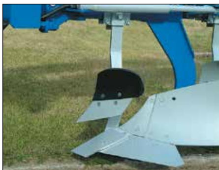
Przedpług EP. Odkładnica z tworzywa sztucznego o najkorzystniejszych właściwościach ciernych.
