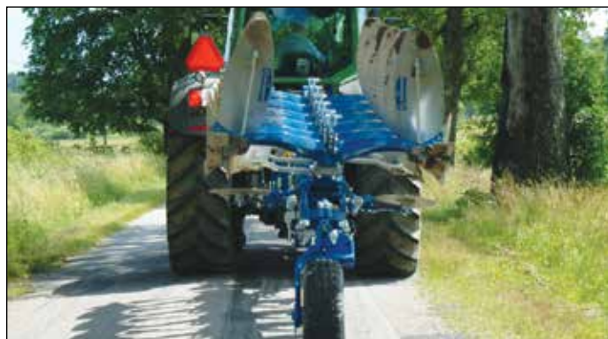
Ustawienie pługa w położeniu „motylkowym” w celu odciążenia ciągnika podczas transportu.
