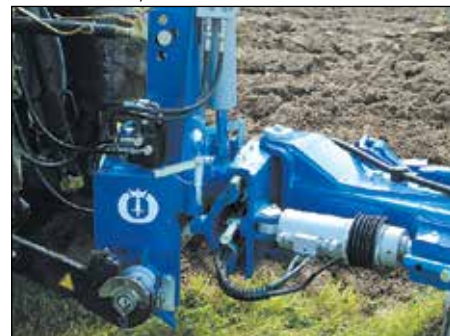
Plóg Xcelsior DX 5975 F z kołem wielofunkcyjnym i z nowo zaprojektowanymi uchwyty do mocowania przedplózków.
