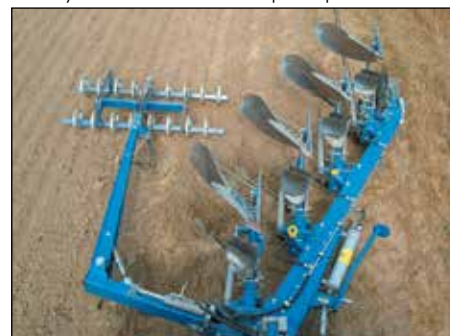
Profil ramy jest szerszy z przodu pługa, gdzie skupiają się siły. Szerokość skib jest regulowana w trzech zakresach.
