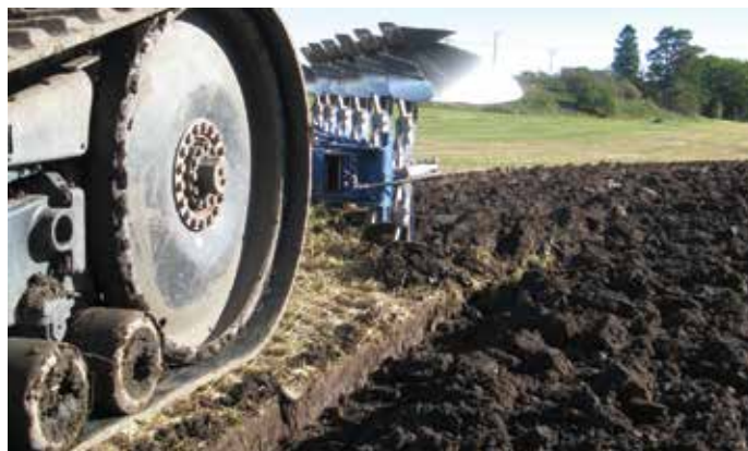
Pług Vari Flex EX On-land może być przesuwany na bok hydraulicznie, aby dostosować go do różnych szerokości ciągnika i wyregulować szerokość pierwszej skiby.
