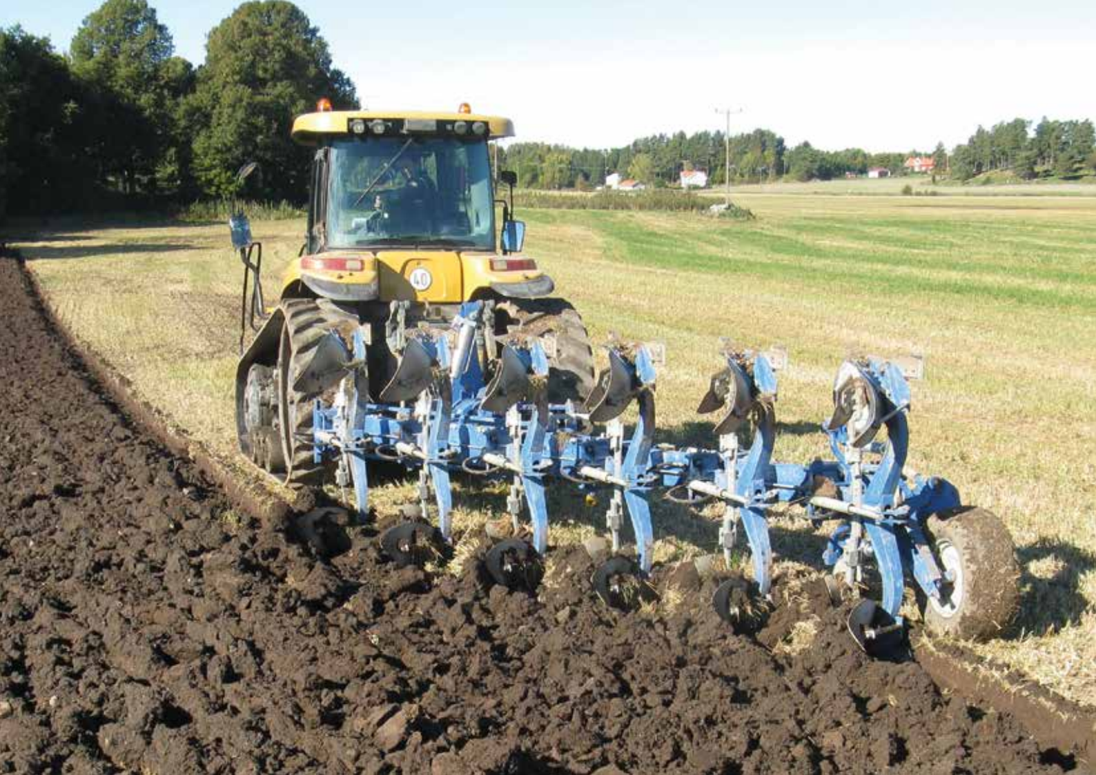
Vari Flex EX On-land 6980 H firmy Overum - elastyczny pług, łatwy do przestawienia z orki po całiznie na orkę w bruzdzie.
