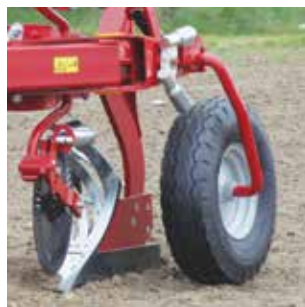
Koło podporowe gumowe (7.00-12) dla typów R i MR.
