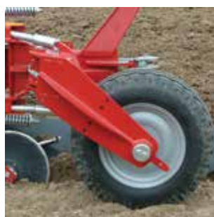
Koło Combi montowane z tyłu dla typu HR and XR. 10.5/65-16 / 340/55-16.
