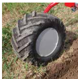
Opona z bieżnikiem rolniczym z osłoną obręczy koła. Zapobiega oblepianiu koła wilgotną glebą
