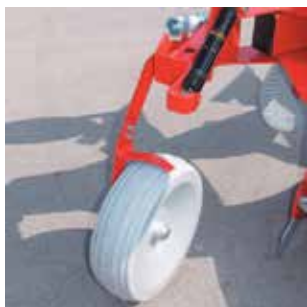
Koło podporowe (500 x 160 mm) stalowe dla typów R i MR.
