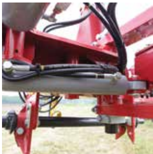
Hydrauliczna regulacja szerokości pierwszej skiby.
