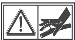
**Ne jamais essayer de déconnecter un flexible hydraulique lorsque le système est sous pression!**
