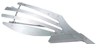
**Le corps AS** est un corps à claires voies, avec 4 bandes remplaçables individuellement. Utilisable dans tous les types de sol, il est particulièrement efficace dans les terres collantes permettant un très bon émiettement. Largeur de travail à partir de 40 cm, et profondeur jusqu'à 30 cm.
