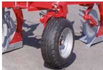
**Roue pneu (combinée contrôle de profondeur/transport) - ø 10.5/65-16/10**
