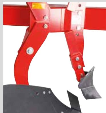
Boulon 16 mm 10.9, déclenchement à 4000 kg
