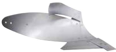
**Le corps AX** est un corps, qui requiert peu de puissance. Ce corps est universel, utilisable dans tous les types de sol, pour des profondeurs de 10 à 28 cm, avec des largeurs de travail de 30 à 55 cm.
