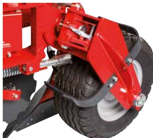
**Roue pneu (combinée contrôle de profondeur/transport) - 260/70-16 - 340/55-16**
