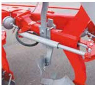
Cette sécurité est conçue pour le labour en présence de pierres afin de protéger la charrue et le tracteur. Elle permet aux corps de labour de s'escamoter lors de la rencontre avec un rocher et de retrouver sa position de travail sans arrêter. La pression de déclenchement est réglable individuellement sur
