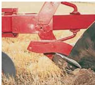
Ce système est conseillé pour le labour dans les sols avec peu de pierres. Cette conception simple permet de réduire le poids, le coût d'investissement et d'avoir le centre de gravité de la charrue proche du tracteur, ce qui réduit la puissance de relevage du tracteur. Le boulon de cisaillement haute résistance donne un effort de déclenchement à la pointe de 4000 kg. Lors du déclenchement, le boulon est cisailé net permettant un remplacement aisé.
