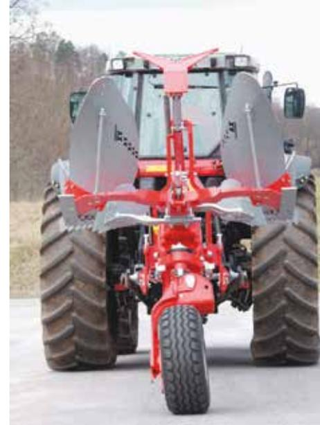
Le blocage tête position papillon est monté en standard sur les charrues type HR/XR et disponible en accessoire sur les types MR.
