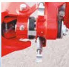
Les charrues type XRW sont équipées avec la roue arrière combinée de contrôle de profondeur/transport (10,65 X 16) qui se manoeuvre aisément de la position transport à la position travail. Cette roue est équipée avec trois disques à friction pour un fonctionnement en douceur lors des retournements.
