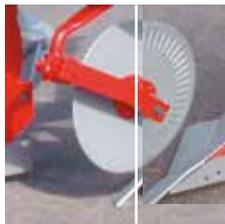
Coutre circulaire, gauf-fré ou lisse, rigide ou sur ressort, diamètre 450 ou 500 mm
