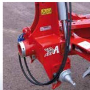
De part son attelage automatique, cette charrue est facile à atteler au tracteur. Les charrues type R et MR sont équipées d'une fusée de 125mm de diamètre montées sur coussinets synthétique, sur lesquelles le jeu axial peut être rattrapé. Attelage catégorie 2 avec réglage de la hauteur la barre d'attelage sur deux positions sur charrue type MR.
