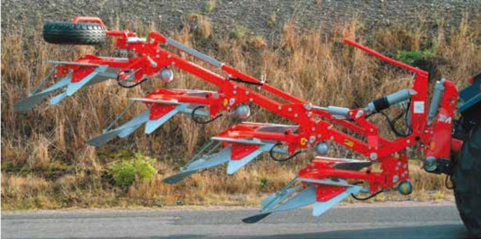
Avec le retournement versoir en dessous, il n'y a aucun risque d'abîmer la roue de contrôle de profondeur.
