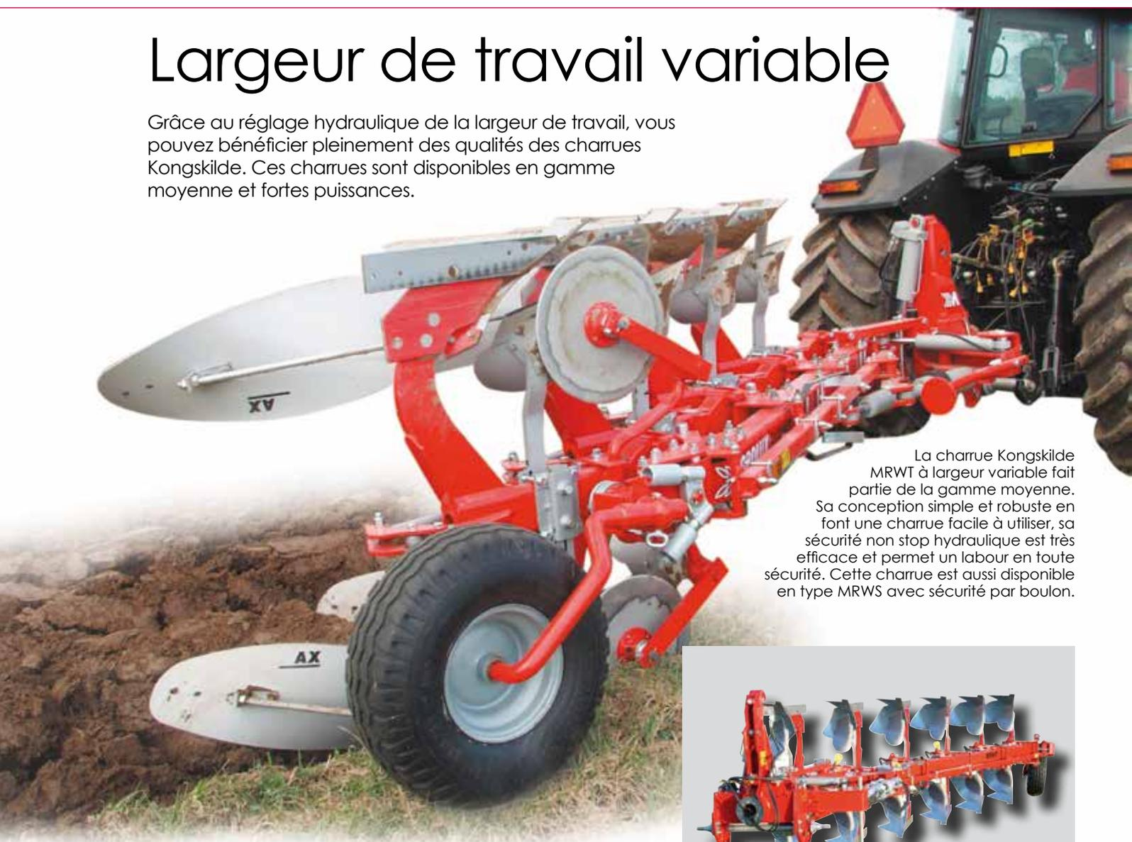
La charrue Kongskilde MRWT à largeur variable fait partie de la gamme moyenne. Sa conception simple et robuste en font une charrue facile à utiliser, sa sécurité non stop hydraulique est très efficace et permet un labour en toute sécurité. Cette charrue est aussi disponible en type MRWS avec sécurité par boulon.
