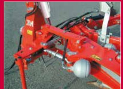
Le système Easy Set est monté en standard sur les charrues type MR. Le réglage hydraulique de prise de première raie est disponible en accessoire.
