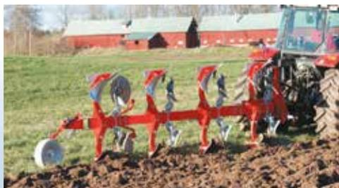
La charrue Kongskilde type RS est une charrue légère conçue pour sol léger, avec sécurité par boulon de cisaillement.
