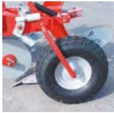
Roue de contrôle de profondeur pneumatique pour charrue type R et MR.
