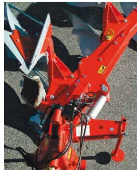
La poutre principale est renforcée par deux plaques massives.
