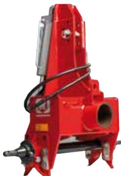
**Cabezal 125:** Se refiere a la dimensión del eje. Diseñado para tractores de hasta 180 CV. Enganche Cat. II y III.
