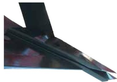
que para otros arados. Kongskilde realizar tres tipos de puntas para mejorar el rendimiento en diferentes situaciones. **Voltear:** Para mejorar la capacidad e incrementar la vida útil. **Nivelar:** mejora el flujo del material y la adherencia mínima en suelo pegajoso. **Överum especial:** punta corta para condiciones rocosas.
