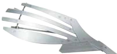
**El modelo AS** es un cuerpo con 4 tiras individuales. Adecuado para todos los tipos de suelo, particularmente para suelos pegajosos. Perfecto volteo en terrenos con pendiente. Para anchos de trabajo de 40cm y profundidad de trabajo por debajo de 30cm. ▶
