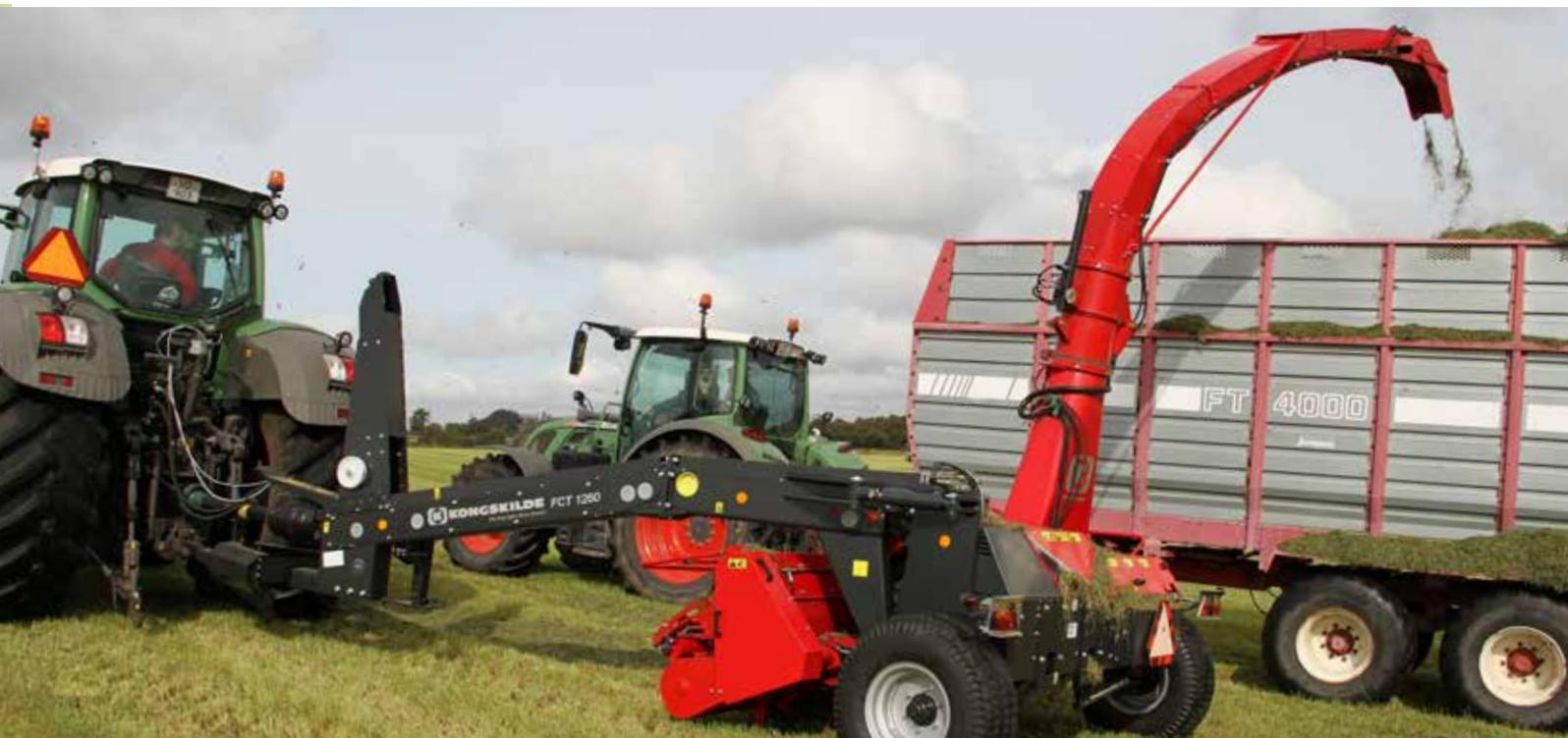
El rotor de corte es más pesado y atrae más aire hacia el conducto, lo que le da a Upper Cut un aumento de capacidad de hasta un 25% en comparación con diseños anteriores. Esto significa que los bloqueos en la sección de entrada de alimentación se reducen al mínimo y se obtiene un lanzamiento largo y potente del cultivo desde la tolva.
