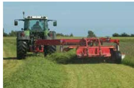
La segadora GMT L /Flex puede equiparse con la cinta hileradora "Collector" para doble hilera. Con este equipamiento es posible agrupar hileras para las siguientes máquinas y optimizar de esta forma la cadena forrajera.
