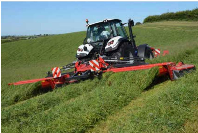
Con la combinación triple GXS puede incrementarse aún más la capacidad de trabajo. El modelo GXS 9005/9005 P es una segadora suspendida a tres puntos, que combinándola con una frontal se consigue un ancho de trabajo de 8.60 m y un rendimiento sobre 15 ha/h.
