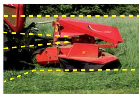
Oscilación de los extremos de la barra de corte, manteniéndola siempre paralela al suelo.
