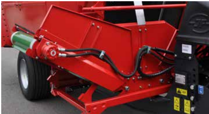
La serie X flexibilidad 4 en 1 cinta transportadora (plana – al lado – elevador derecha e izquierda) – VM-SB X y VM-B X.
