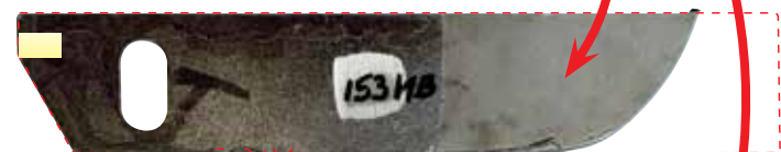
Acero de calidad ($355) después del test
