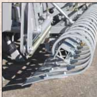
Izlīdzināšanas plātne izveido sēklas gultni pirms sēšanas.
