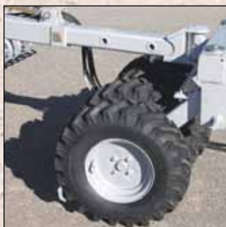
HT-S modeļi var tikt aprīkoti ar starprīteņu blīvētāju, lai izlīdzinātu augsni starp traktora riteņiem.
