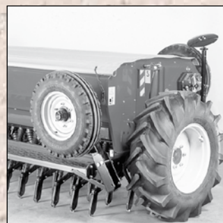
H. modeļiem ir sānos novietoti riteņi. Ir pieejami arī atsevišķi transporta riteņi.
