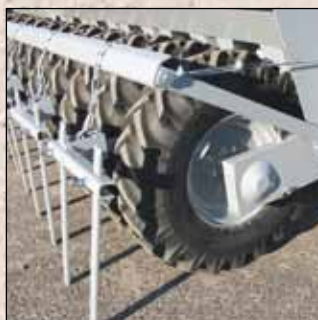
HT modeļos patentētie aizmugurējie riteņi ir sadalīti 0,5 metru sekcijās.
