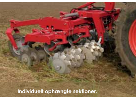
Lavt trækpunkt foran på Front Terra Disc.
