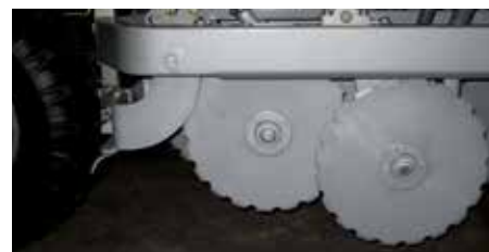
Gødningsskærene kan løftes, når de ikke bruges.
