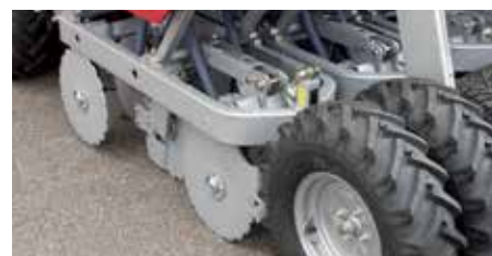
Sådybden styres af den forreste række hjul.
