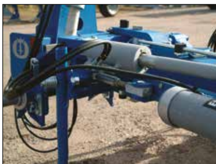
Med strekkfisken balanseres alle sidekrefter for å oppnå minst mulig trekkraftbehov.
