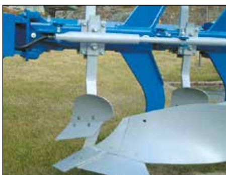
EG-skumplog. Gir en grunn, bred skumming. Fungerer utmerket sammen med både kniv og rullekniv.
