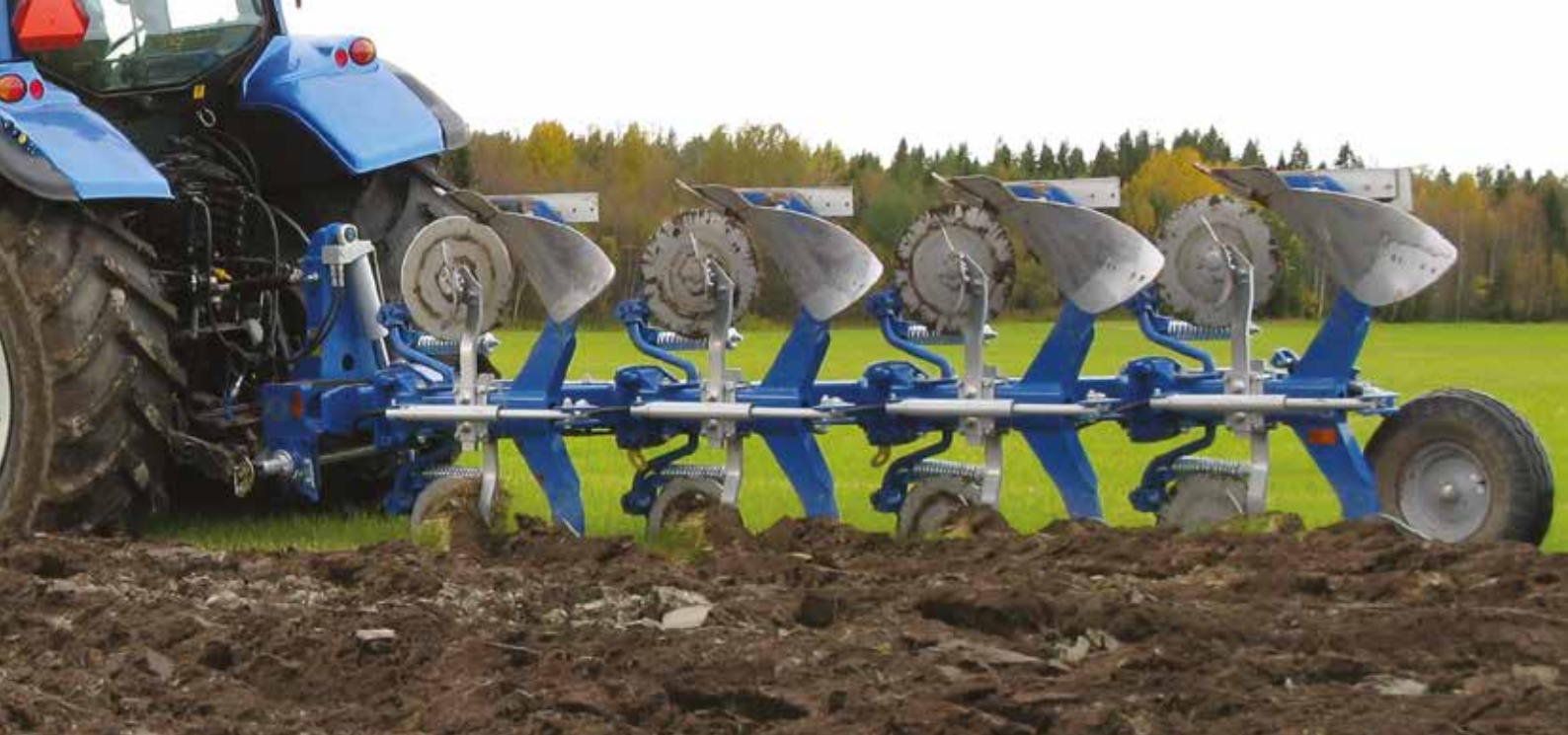
Xcelior CX 4975 H med rullekniver og EG-skumplog. Arbeidsbredden kan stilles manuelt fra 140-180 cm.
