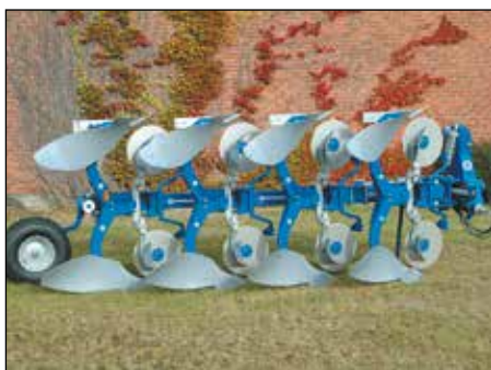
Vari Flex CX 4975 F med faste rulleskjær og EG-skumplog. Både kropp og rulleskjær er utstyrt med bruddbolter.
