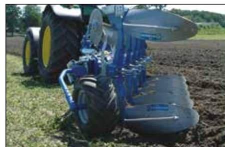
Nytt, kraftig støttehjul med større innstillingsområde. Vendingen dempes av en justerbar friksjonsbrems. Det brede dekket har god bæreevne og liten rullemotstand.
