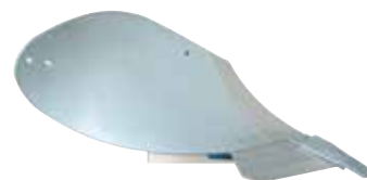
XU-kropp med kort veltefjøl for brede velter og djup pløying.
