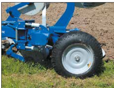
Kombihjul Xcelsior / Vari Flex DX. Dimensjon 10,5x16. Diameter 755 mm, bredde 275 mm.
