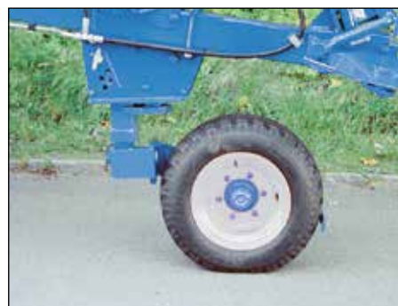
Kombihjul i framskutt posisjon for Xcelsior DX. Diameter 755 mm, bredde 275 mm.
