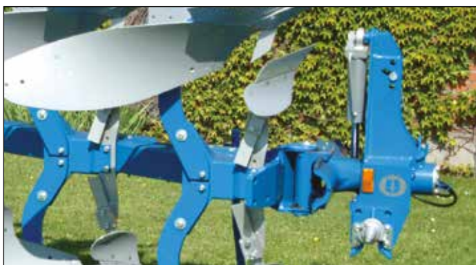
Xcelsior CX er utstyrt med nykonstruert vendehode.
