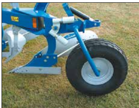
Pendelhjul med gummidekk 7,00x12. Diameter 645 mm, bredde 182 mm.
