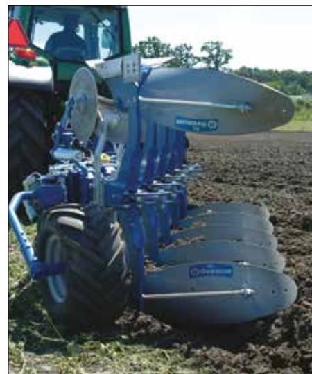
Nytt, kraftig støttehjul med større innstillingsområde. Vendingen dempes av en justerbar friksjonsbrems. Det brede dekket har god bæreevne og liten rullemotstand.
