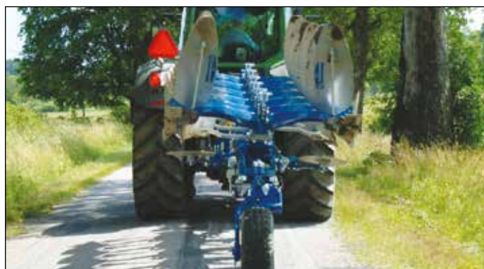
Omstilling til "butterfly" posisjon under transport, avlaster traktoren.
