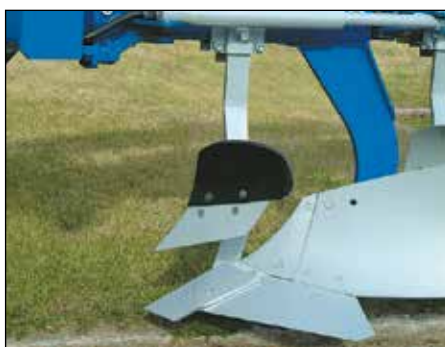
EP-skumplog. Den plastbelagte veltefjøl forhindrer at klebrig jord fester seg.
