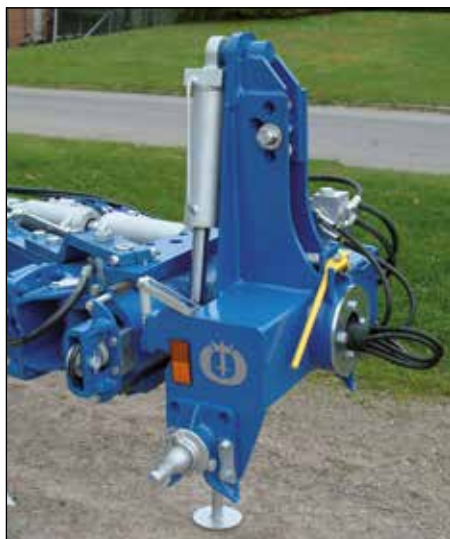
Det kraftige vendehodet med 150 mm aksling og kulelagre er dimensjonert for traktorer opp til 200 hk.
