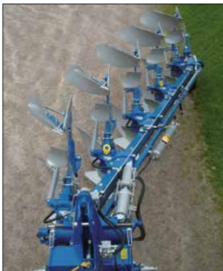
Perfekt geometri på bredde-reguleringen gjør at endring av fårbredde utføres lett og med minimal slitasje på alle ledd.
