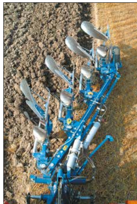
Presisjonsborede, skrudde forbindelser gjør det mulig å benytte høyfast stålqualität i hovedrammen.
