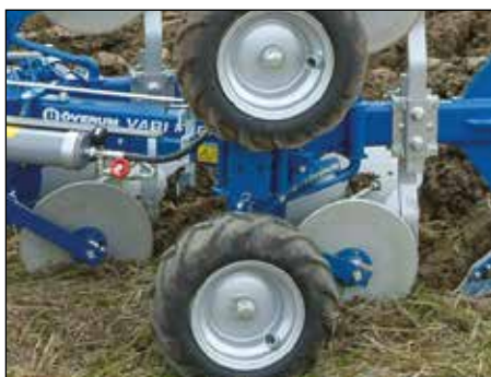
Dobbelthjul i framskutt posisjon. Diameter 572 mm, bredde 210 mm.
