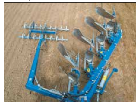
Rammens bredde er størst i framkant, der belastningen også er størst. Arbeidsbredden er justerbar i tre trinn.
