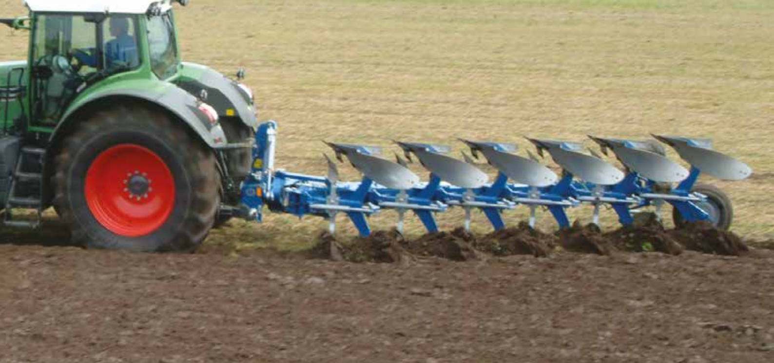
Vari Flex EX 6975 H med hydraulisk justerbar arbeidsbredde på opp til 3,3 meter.
