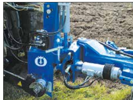
Dragaksling med hurtigkobling for rask og trygg kobling.
