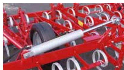
Vérin hydraulique double effet pour le repliement des extensions.
