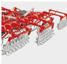
Herse à rouleau fils CEGC/REGC Pour sol léger et moyen. Nivellement après le passage des dents, brise les grosses mottes et tasse la couche supérieure.
