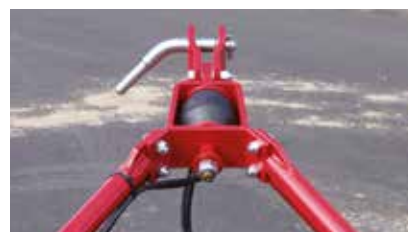
Amortisseur caoutchouc pour protéger le vibroculteur et le tracteur.
