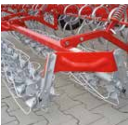
Herse à rouleau cranté double CDGC/RDGC Pour sol lourd, sans pierre. Donne une préparation plus intense du sol.
