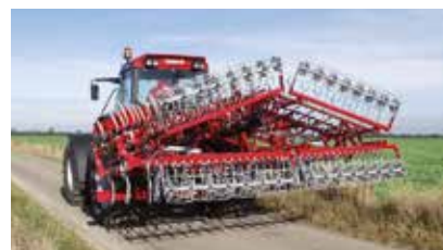
Les extensions latérales sont repliées sur le bâti central.
