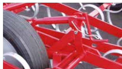
Réglage par manivelle avec échelle graduée. Roue pneumatique 6.00 x 12 équipant en standard le SGC.
