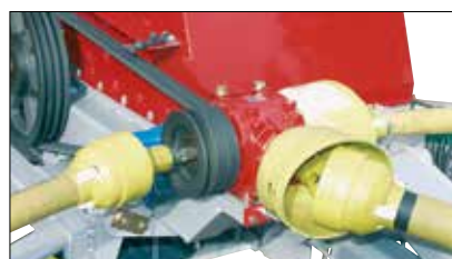
Napęd jest przenoszony przez przekładnię kątową i przekładnię pasową.
