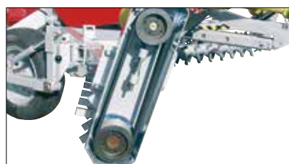
Przekładnie z pasami klinowymi napędzają wałki zgarniające.
