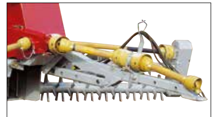
Regulacja głębokości pracy sita za pomocą przegubowo połączonych dyszla.
