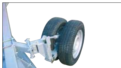
Nastawne podwójne koła regulacji głębokości wałków zgarniających.
