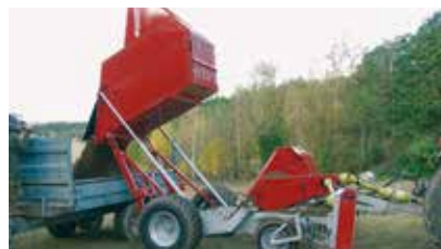
Wyładunek kamieni na wysokość 2,3 m.
