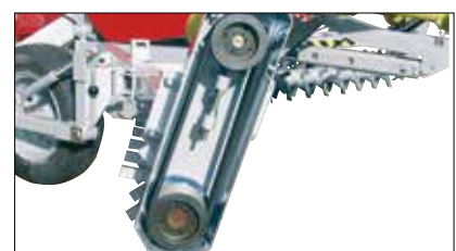
Kraftübertragung des Steinrechens.
