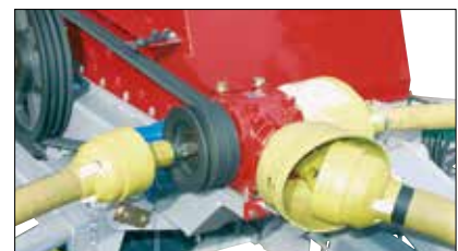
Kraftübertragung des Rotors.
