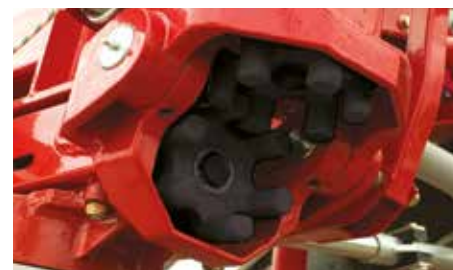
Zespół napędowy palców przekazuje moc pomiędzy zespołami rotorów
