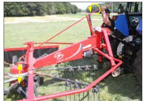
Arbejdshøjden er nem at indstille på det praktiske håndtag over ophængen.
