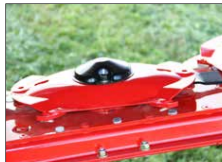
Disky Q+ s kroucenými noži jsou standardní výbavou
