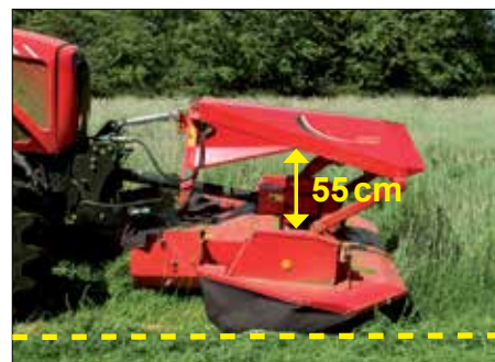
Contour Float – na rovném povrchu
