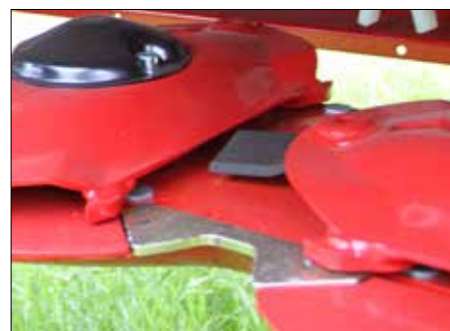
Protioštrí je o 2 mm vyšší než kryt žací lišty
