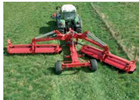
Systém Top Safe snižuje zatížení žacích lišt při vysokých jezdových rychlostech.
