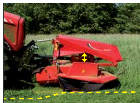
Contour Float – na zvlněném povrchu
