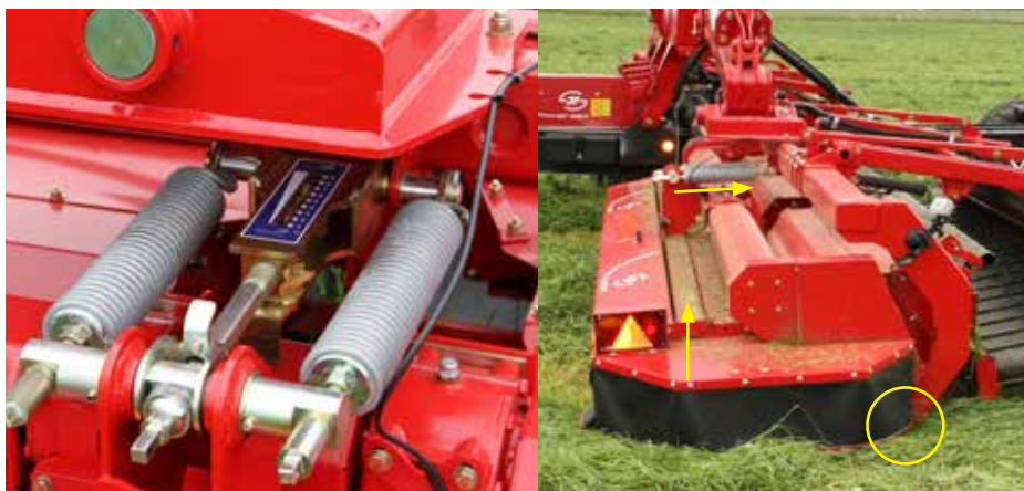
Nastavení výšky řezu je integrované do systému Top Safe.
