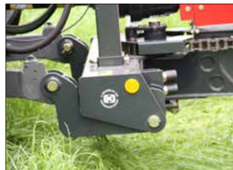
Systém Top Safe snižuje zatížení žacích lišt při vysokých jezdových rychlostech.
