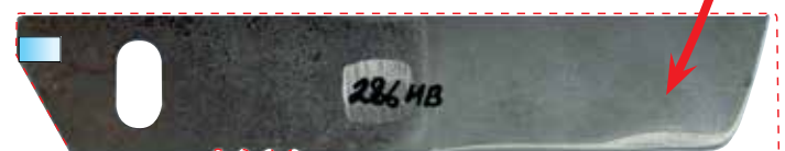
Fijncorrelstaal ($650) na de slijtvastheidstest
