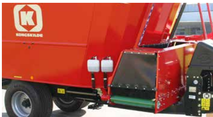
De B-serie voor professioneel voederen met dwarsband aan de voorkant – VM-SB en VM-B
