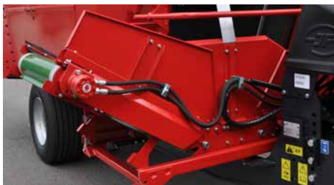
X-serie - de fleXibele 4-in-1 dwarsafvoerband (vlak - sideshift - elevator-band rechts en links) – VM-SB X en VM-B X.
