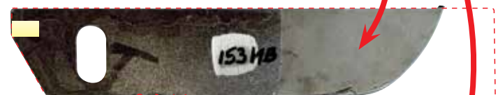
Kwaliteitsstaal ($355) na de slijtvastheidstest
