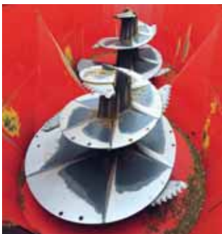
Zowel lange als korte messen op de vijzel. Een aparte uitdrijfarm onderaan de vijzel ontbreekt.
