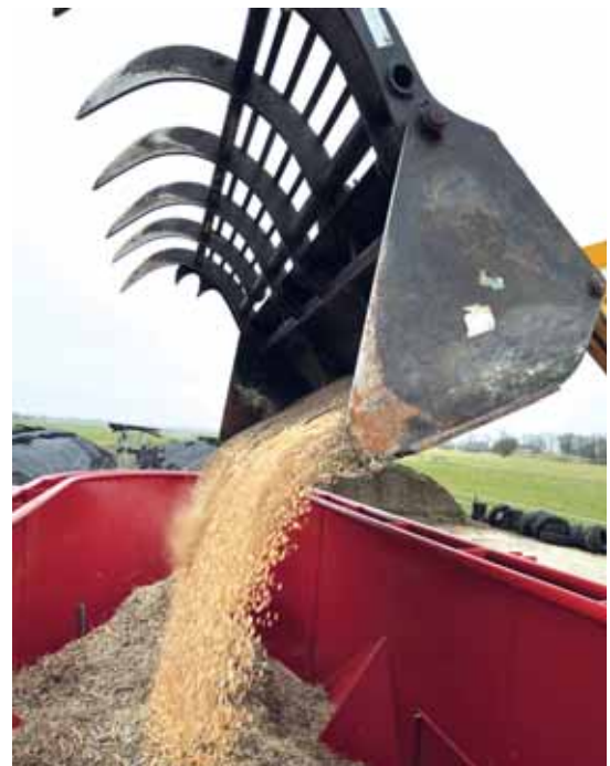
Om de verdeling van kleine componenten te beoordelen worden goed traceerbare maiskorrels bijgemengd.
