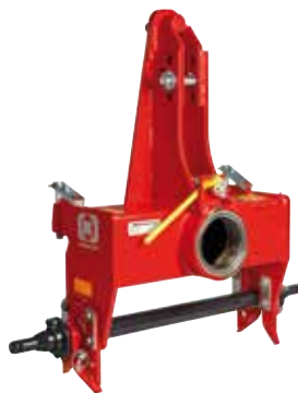
Aankoppelbok 150: dit is de afmeting van de holle as. Voor probleemloos ploegen met tractoren tot maximaal 220 pk. Koppelas cat. II en III.
