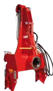
Aankoppelbok 180: gebouwd voor intensief gebruik, deze aankoppelbok past perfect bij de grootste ploegen. Maximaal 360 pk. Uit slechts 1 stuk geproduceerde, warmte-behandelde holle as van hoge kwaliteit, 150 mm tot 180 mm.
