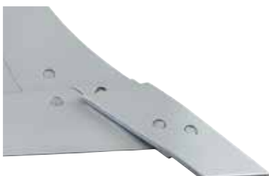
Punten: de schaarpunten op de ploeglichamen van Kongskilde zijn extra lang en zo ontworpen dat de slijtage gedurende de levensduur gelijkmatig verloopt. Het ontwerp zorgt voor een goed contact met de grond; nieuwe punten breken door de uiteindelijke ploeglaag heen. De lange punt is uitzonderlijk slijtvast.
