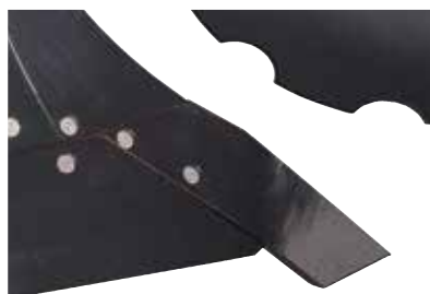
De punt, de schaar en het rister bevinden zich in hetzelfde vlak op een Kongskilde-lichaam. Dit betekent dat de slijtage gelijkmatig wordt verdeeld, minder vermogen nodig is, de materiaalkosten lager zijn en er minder risico is dan bij andere ploegen dat er grond aan het rister hecht. Kongskilde voert drie soorten
