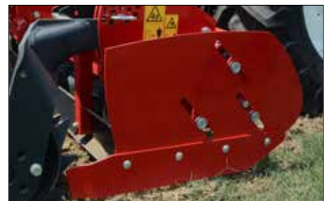
Zijplaat kan van voor naar achter bewegen.
