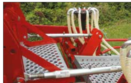
Door middel van een topstang zijn de kouterbalk en de tank met elkaar verbonden hierdoor kan de hoogte van de kouterbalk worden aangepast.
