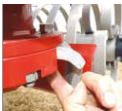
Verwijderen van de bevestigingspen die de tand borgt
