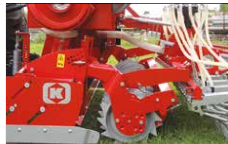
Parallele constructie van de koppeling van het koutergedeelte. Het is niet nodig om de positie van het koutergedeelte aan te passen wanneer u de werkdiepte wijzigt.
