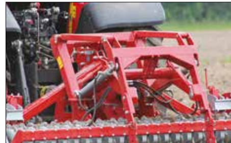
Hydraulische aanbouwdelen met een hefvermogen tot 3,5 ton.
