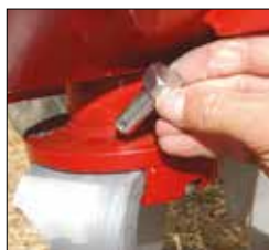
Pen met semi-6-kant kop die niet kan draaien.
