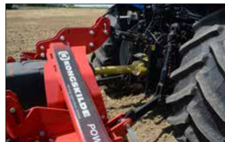
Driepunt met geïntegreerde aanspanpunten.
