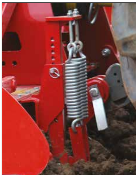
Sporenwisser met dubbele veer.
