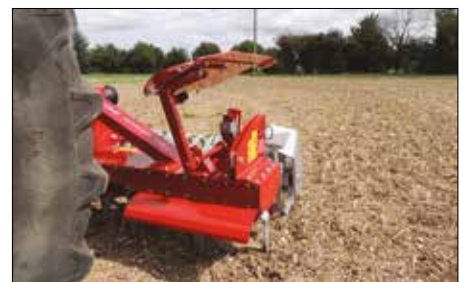
Zijplaat in positie voor wegtransport.
