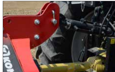
Topstangpen kan niet draaien.
