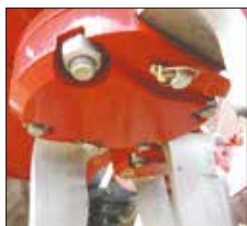
Rubigpen geïntegreerd in de rotorflens.
