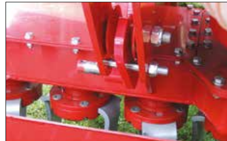
Snelkoppeling van de NS 4100 tank
