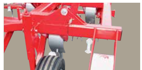
VF 4200 / 4300 / 4000 Wiel 6.00 x 12" met spindel-verstelling.
