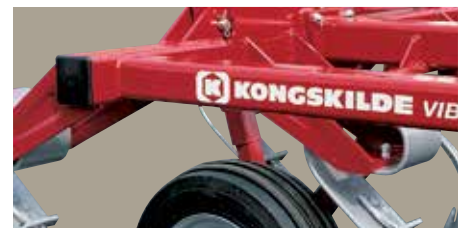
VF 2000 / 4200 / 4300 / 4000 Frame van zwaar kokerprofiel.
