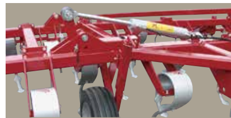
VF 4200 / 4300 / 4000 In- en uitklappen met dubbelwerkende cilindres.
