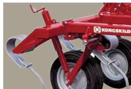
VF 4200 / 4300 / 4000 Rubber wiel 24 x 8.00 - 14.5 met spindelverstelling.
