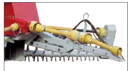
La profondità di lavoro è controllata dalla barra di attacco idraulica.
