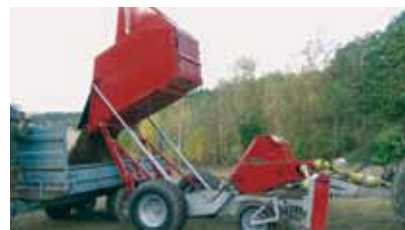
Altezza di scarico di 2,3 m.
