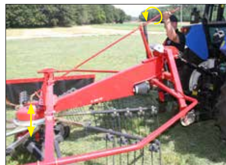
Wysokość robocza. Wysokość roboczą można łatwo regulować za pomocą praktycznej dźwigni nad układem zawieszenia.
