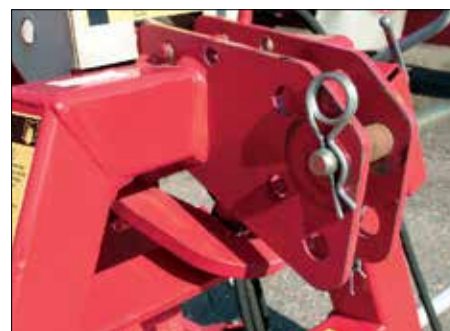
3-punktowy układ zawieszenia stanowi standardowe wyposażenie
