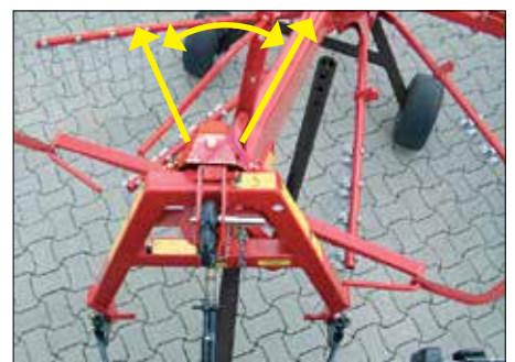
Tříbodový závěs s kloubovým spojením byl vyvinutý proto, aby shrnovač bezpečně za všech okolností sledoval stopu traktoru.
