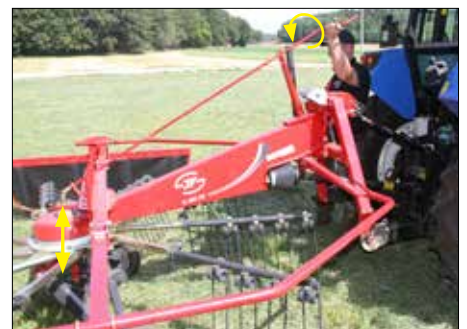
Pracovní výšku lze snadno nastavit pomocí kliky umístěné nad závěsem.
