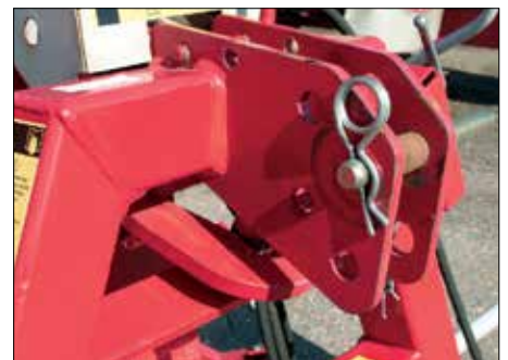
Tříbodový závěs s kloubovým spojením je standardní výbavou.
